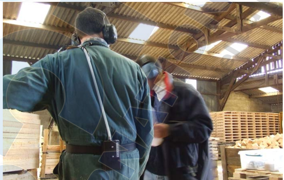
Prélèvement en scierie : équipement d'un opérateur avec la pompe (vue de face, ci-dessous vue de dos). Elle est reliée par un tuyau à une cassette (cf. photo page précédente) dans laquelle se trouve le filtre à poussière.
