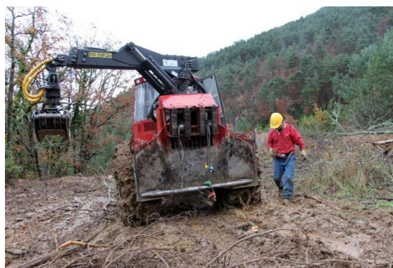
Configuration 2 : Débusqueur double treuil, équipé d'une grue et d'un grappin, évoluant plutôt dans les petits bois et bois moyens (inf 1m 3 ) : 2 lignes de câble équipées chacune de 4 chokers coudés et de 4 élingues. Dans le test, une seule ligne était équipée de 4 chokers automatiques installés sur les élingues
