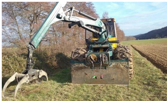
Configuration 3 : Débusqueur double treuil équipé d'une grue et d'un grappin large, intervenant principalement en récolte de bois énergie (groupes de javelles) : 2 lignes de câble chacune équipées d'un choker automatique et d'un culot métallique en terminaison
