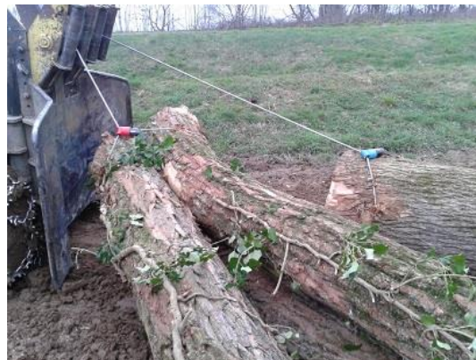
Configuration 1 : Débusqueur double treuil, intervenant principalement dans les gros bois (1 à 2 grumes /ligne de câble) : 2 lignes de câble chacune équipée d'un choker automatique et d'un culot métallique en terminaison
