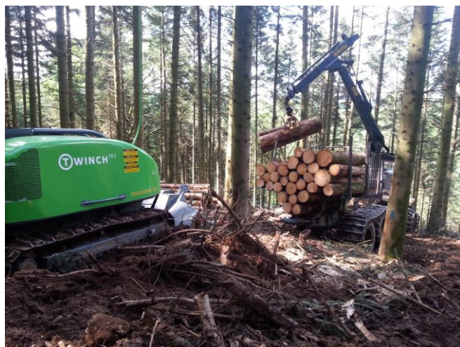
Photo 3 : T-WINCH offrant son assistance synchronisé au porteur du chantier de St Denis des Murs
