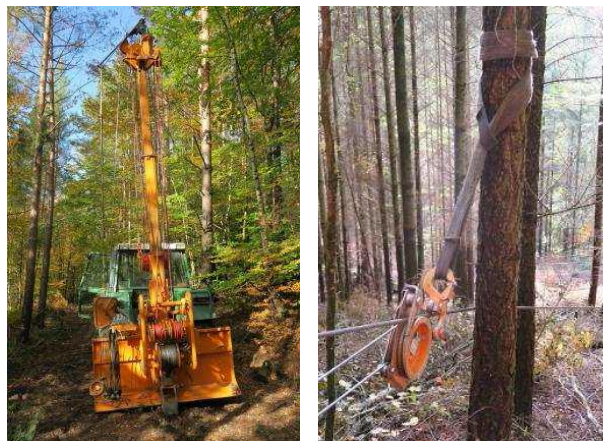
Photo 4 : Petit câble-mât Ritter KSK3 et poulie du câble retour accrochée sur le cabestan porteur à hauteur d'homme
