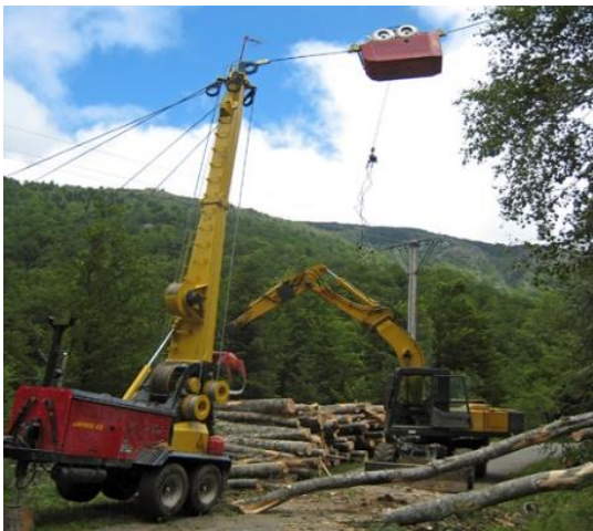
Photo 1 : une configuration classique en France : câble mâât sur remorquen chariot automoteur et pelle munie d'une tête de façonnage
