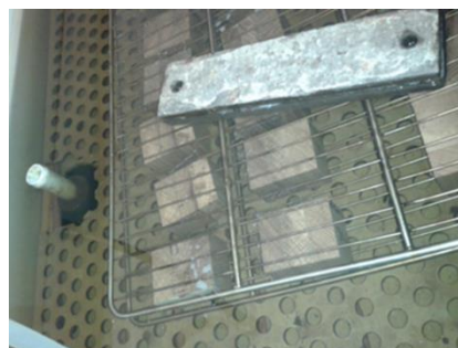
Photo 6 : Immersion 16 h dans l'eau à 20°C
