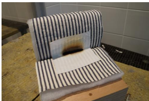
Photo 2 : Test feu TB 117 – 2013 Section 3 matériaux résilients au Laboratoire Feu de FCBA à Champs-sur-Marne (FR 77)
