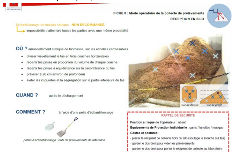
Figure 5 : description d'un mode opératoire : prélèvements de biomasse sur un tas de matière dans un silo de plain-pied
