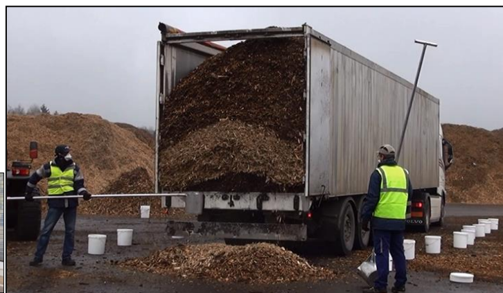
Photo 2 : Echantillonnage de 30 prélèvements dans un camion très hétérogène (3 produits en couches)
