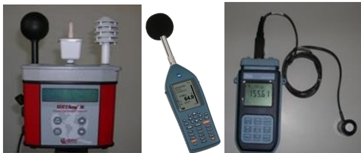
Photos 2 : Exemples de capteurs utilisés : station de confort hygrothermique – sonomètre – luxmètre
