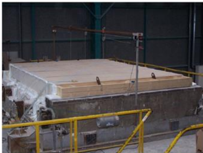
Photo 2 : Plancher installée sur le four de résistance au feu
