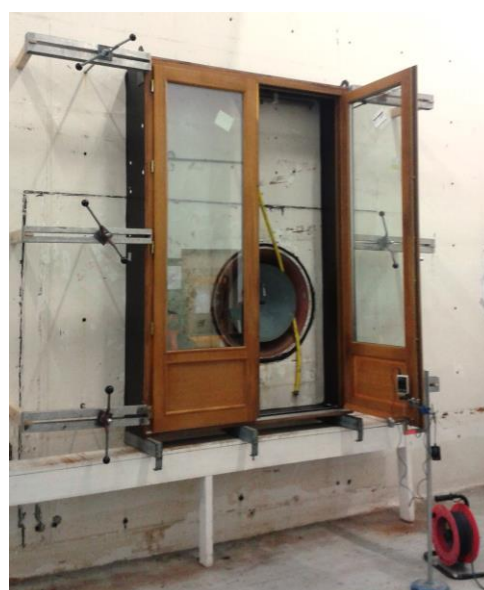
Photo 1 : Prototype de porte-fenêtre bois sur le banc d'essai de l'Institut Technologique FCBA de Bordeaux
