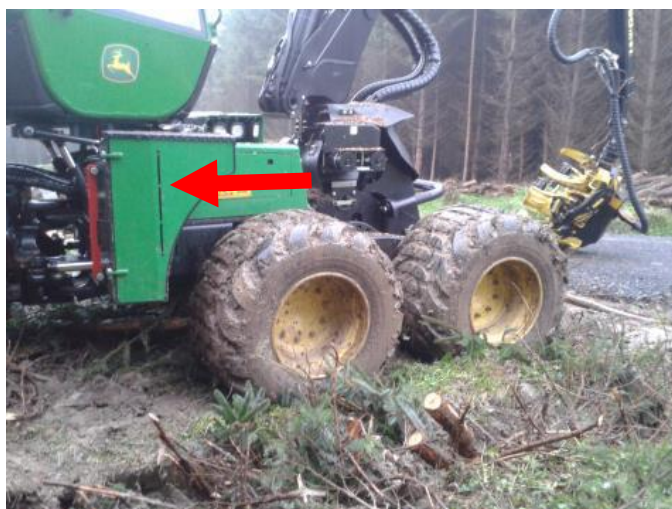
Photo 5 : Réservoir d'urée sur la partie droite de la machine avec une fente permettant de voir le niveau (contrôle visuel uniquement, pas d'info au niveau de l'ordinateur de bord)
