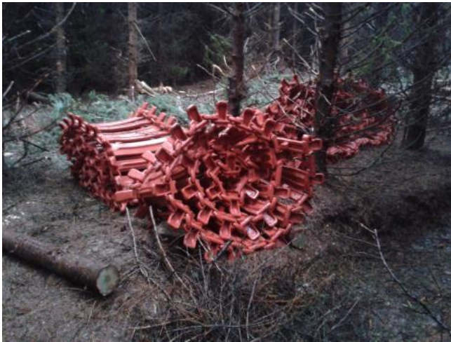
Photo 1 : Tracks métalliques (Clarks et Olofors) de type mixte : tuiles larges pour la portance et tuiles à barrettes pour l'adhérence
