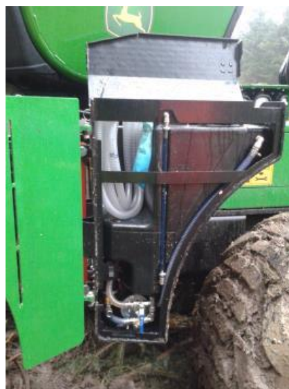
Photo 6 : Réservoir d'urée : pompe avec un manchon de traite détourné et doté d'un filtre « maison » bleu à l'extrémité du tuyau d'alimentation pour éviter l'encrassement du réservoir
