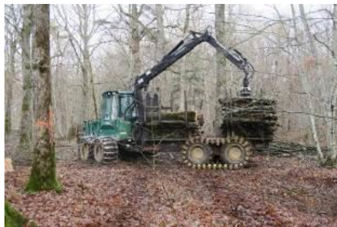
Photo 6 : Exemple de porteur tracksé métalliques à l'avant pour améliorer la motricité en zone de pente et synthétiques à l'arrière pour améliorer la portance
