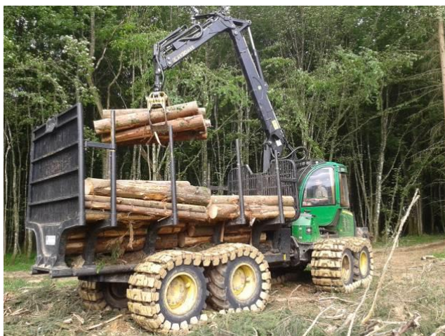
Photo 2 : Le porteur équipé de 4 tracks RAUP F Capacité de chargement 12 T / Masse totale à vide avec tracks ~20 T
