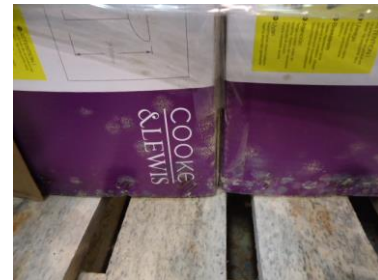
Photo 3: développement de moisissures dans un container maritime
