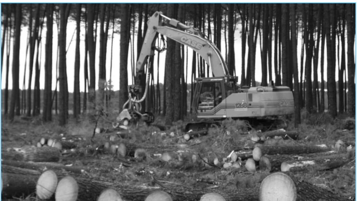
Exploitation mécanisée en coupe rase d'un peuplement de VU 0,8 m 3 .
