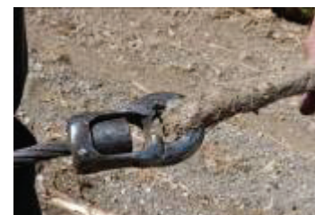
Modification d'un chocker droit par soudure d'un 1/2 anneau : l'épissure est protégée, terminaison durable avec une soudure de qualité
