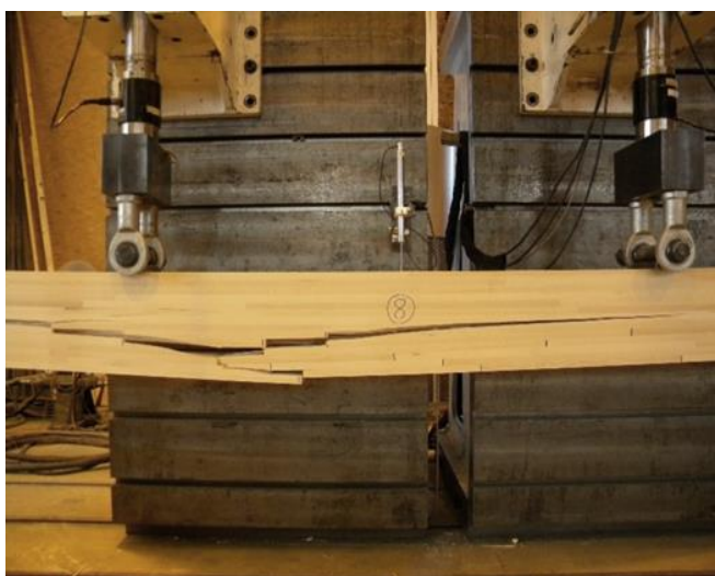
Photo 4 : Poutre BLC hêtre en flexion. La position des aboutages (point faible des poutres) a été identifiée sur les lamelles les plus mécaniquement sollicitées
