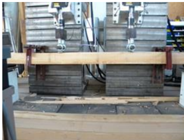
Photo 3 : test de flexion sur une poutre hêtre (EN 408)
