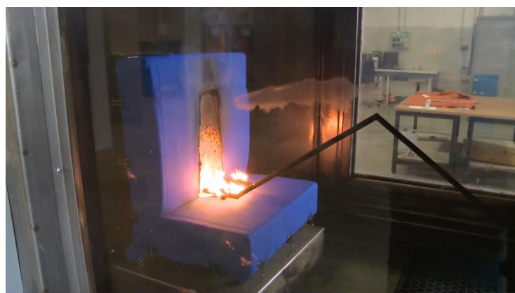
Photo 1 : Test de feu sur fauteuil rembourré à FCBA
