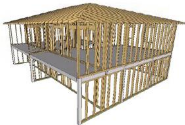
Figure 8 : Ossature bois en parois verticales et dalle béton source : Intégral Bois System
