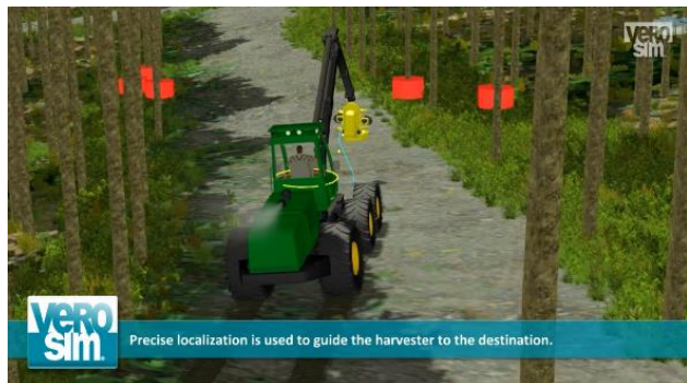
Photo 12 : Concept d'abatteuse automatique
