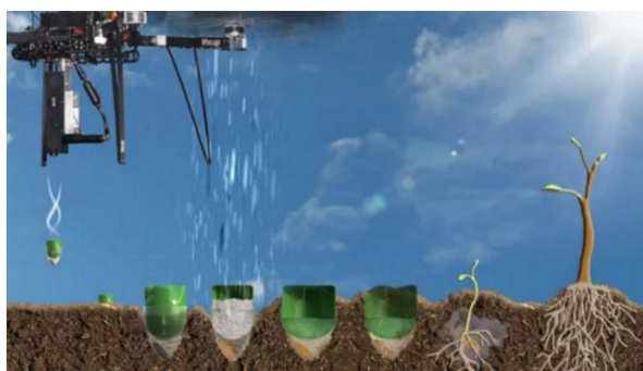
Photo 13 : Drone planteur d'arbres (crédit photo Drone Below)
