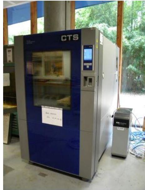
Enceinte climatique : matériel permettant de simuler différents environnements climatiques en température, humidité et vitesse d'air
