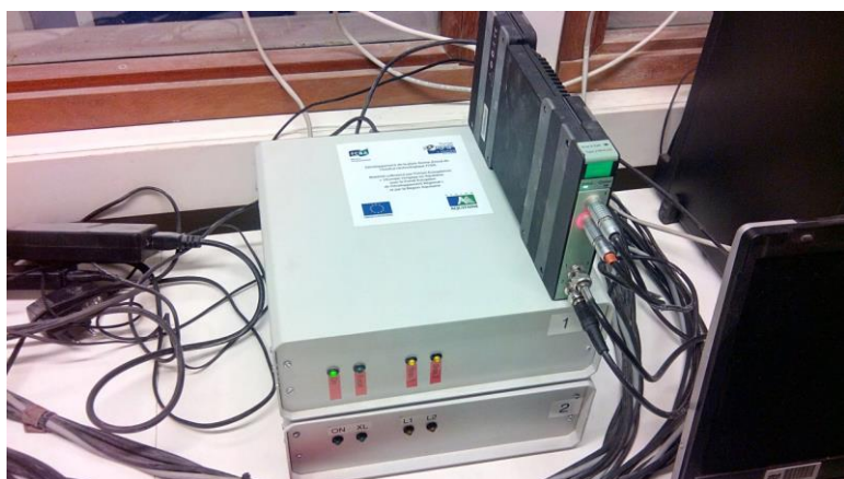
Analyseur acoustique : mesure des performances d'isolation et d'absorption acoustique
