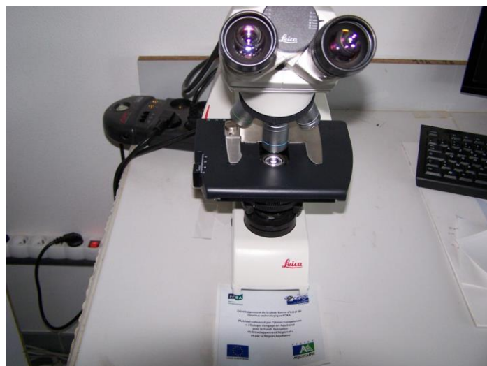
Microscope avec caméra et platine lumière réfléchié : observation de matériels biologiques, agents de dégradations biologiques du bois ; observation microscopique de surfaces
