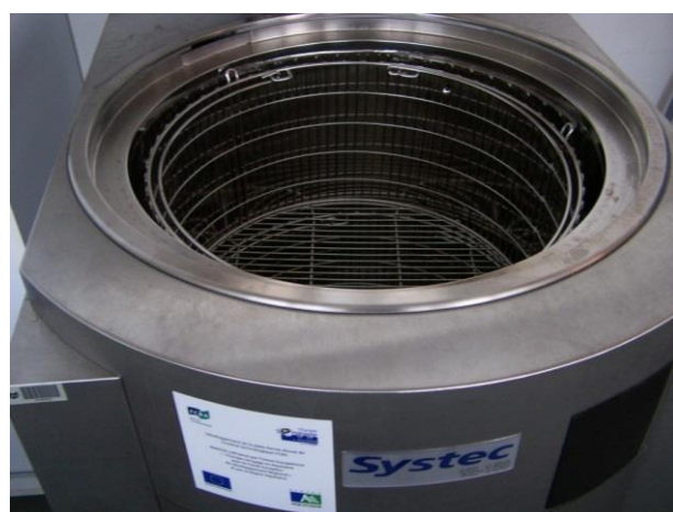
Autoclaves vertical et automatique : stérilisation de matériel de préparation pour cultures biologiques
