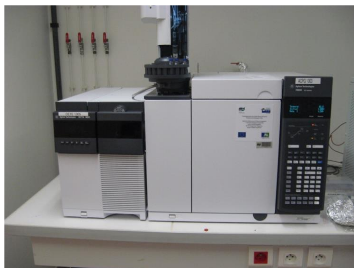
Chromatographie phase gazeuse avec détection par spectrométrie de masse (GC-MSD) : dosage des COV selon la norme ISO16000 (QAI)
