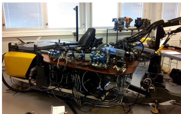
Figure 4 : Banc hydraulique simulant le fonctionnement d'un porteur pour la formation des stagiaires
