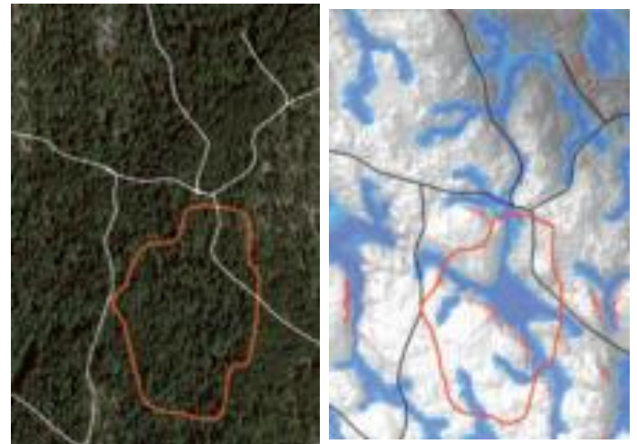
Scéma 2 : exemple de visualisation du risque humidité (sol détrempé) dans l'outil WAM (Wet area map) en cours de développement chez le partenaire Skogforsk
