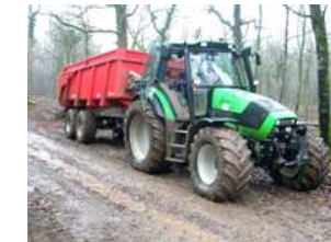
Matériel classique de l'exploitation agricole Capacité des bennes : de 15 à 24 m 3
