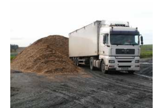
Benne à fond mouvant Capacité importante : de 80 à 90 m 3 Déchargement autonome : moins de 15 minutes pour 90 m 3
