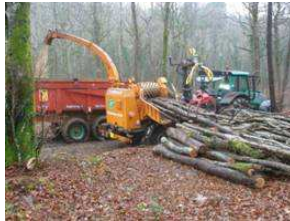
Déchiqueteuse alimentée par la prise de force d'un tracteur (180 à 220 CV) équipée d'une grue
