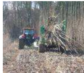
1. Fauchage et mise en bord de parcelle des brins à l'aide d'une remorque récolteuse de tiges entières entraînée par un tracteur
