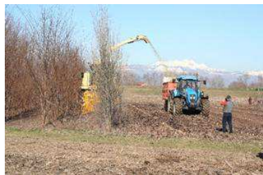
Fauchage et déchetage des brins en plaquettes directement envoyées dans la benne d'un tracteur
