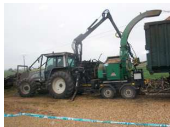
2. Réalisation des plaquettes à l'aide d'une déchiqueteuse
