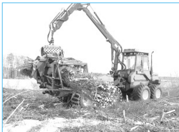
Machine Fiberpac 370 de Timberjack en récolte de rémanents sur un chantier de coupe rase d'épicéas en Finlande.
