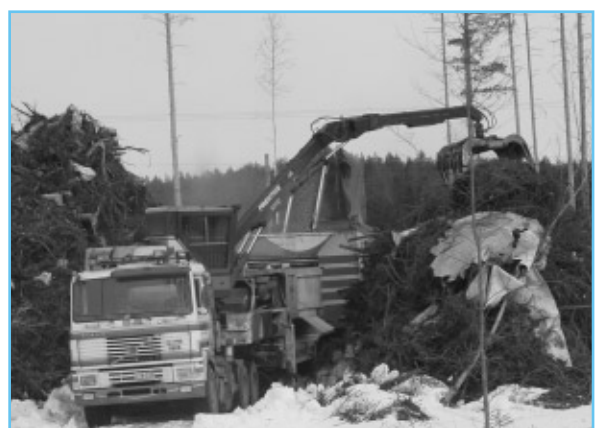
Unité de broyage mobile traitant, en bordure de chantier, des souches et des rémanents de coupe rase de pin sylvestre pour une valorisation énergétique à l'usine UPM Kymmene de Jämsänkoski (Finlande). Pendant toute la phase de stockage sur chantier, qui peut varier de six mois à un an. Les rémanents sont protégés de la pluie et de la neige par une toile de papier spéciale.
