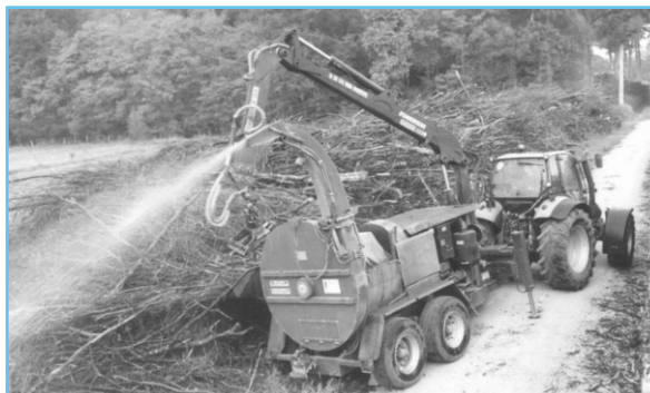
Cette déchiqueteuse sur remorque routière est dotée de son propre moteur et d'une grue.
