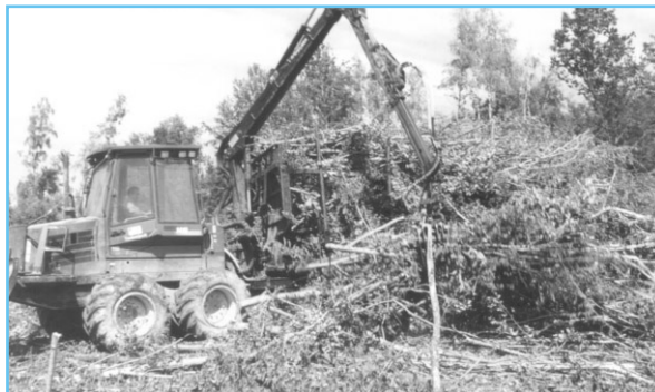
Compte tenu du foisonnement des rémanents, ce porteur est en sous-charge.
