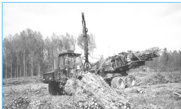
La fagotteuse de John Deere/Timberjack dans des rémanents de peuplier.
