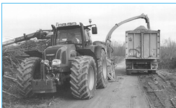
Déversement des plaquettes en conteneur; déchetage direct dans une benne ou un camion, déchetage au sol, de multiples solutions sont envisageables.
