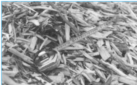
La plaquette forestière peut être obtenue par déchiquetage de bois ronds, de cimes et branches, de rémanents, de chutes diverses.
