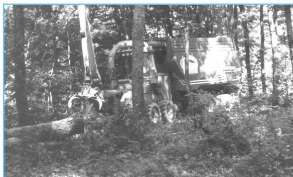
La machine de récolte Silvatec à alimentation axiale est adaptée à la récolte en ligne des résineux.
