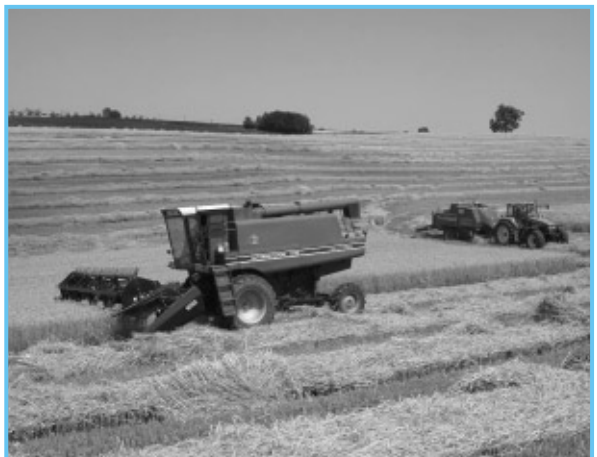
Tarn, 2004, récolte de triticale en plante entière (fauchage et andainage en une opération avec une barre de coupe spécifique puis pressage en balles haute densité).
