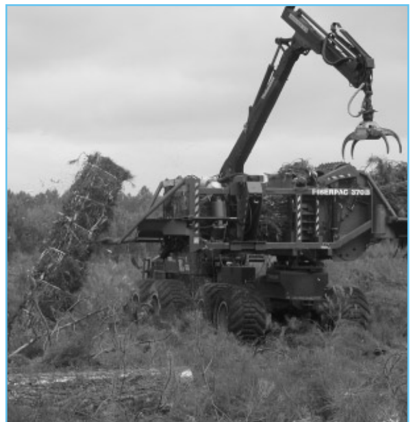
Photo 4 : Récolte de branches de pin maritime sur un chantier de coupe rase en Gironde par la méthode de compression et de mise en fagots. Le déchetage en plaquettes, en vue de la valorisation énergétique, se fera à proximité de la chaufferie.
