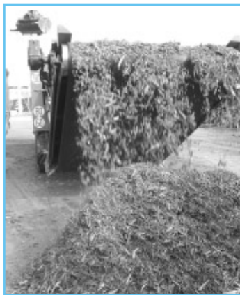
Broyage de souches issues de coupes rases de pin maritime en vue d'une valorisation énergétique dans une chaufferie industrielle.
