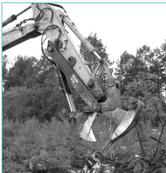
Photo 5: cisaille Pallari KH 160 développée en Finlande pour le dessouchage en forêt et pour une utilisation sur les plate-formes de recyclage ou les parcs à bois. Cisaille avec un seul couteau vertical.
