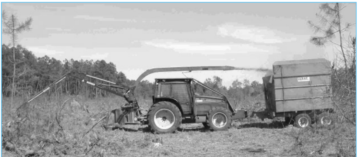
Photo 2 : Ensemble de déchetage mobile, composé d'un tracteur, du broyeur, d'une grue et d'une benne, en récolte de branches après une coupe rase de pin maritime dans les Landes (CAFSA).
