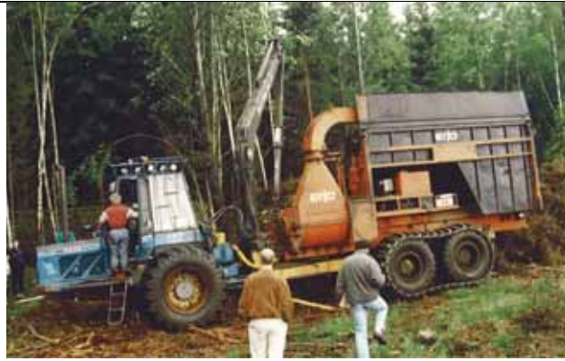
Machine automotrice suédoise sur base de porteur avec moteur auxiliaire + grosse déchiqueteuse à alimentation latérale
