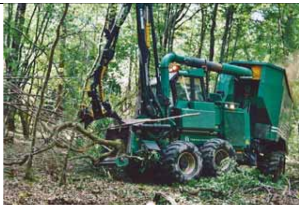
La machine de récolte Silvatec, à alimentation axiale, en houpriers de feuillus
