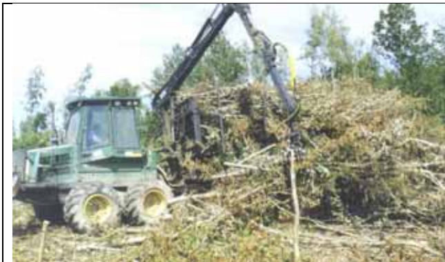
Un porteur Timberjack 8 x 8, capacité 14 tonnes, débardant des rémanents de taillis
