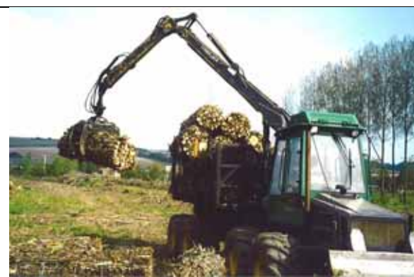
Les fagots (ici en longueur 2m) se prêtent bien à un débardage au porteur
