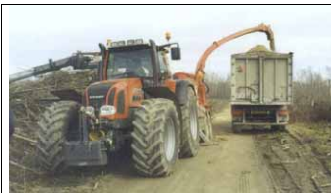
Ce tracteur de 280 CH entraine une déchiqueteuse sur sulky Jenz débitant dans une semi remorque à benne basculante
