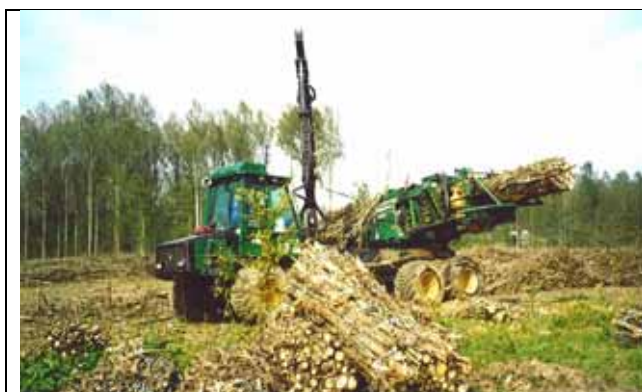
La fagoteuse John Deere Timberjack dans des rémanents de peuplier
