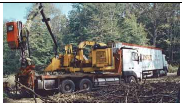
Içi la déchiqueteuse Bandit sur camion à 6 roues débite dans un camion à fond mouvant
