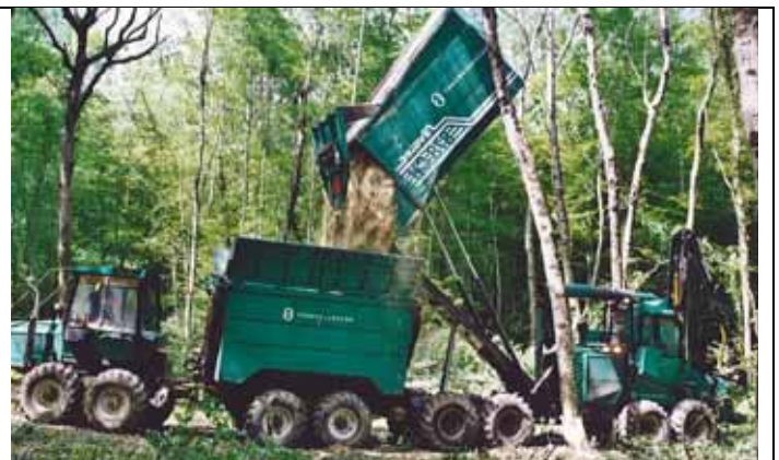
Le transfert de la benne dans le porteur navette qui va débarker les plaquettes et les déverser dans un camion ou conteneur
