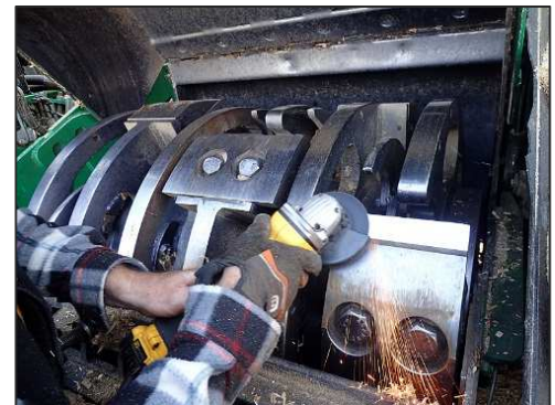
Les bois débardés au porteur sont propres. L'affutage des 12 couteaux de la déchiqueteuse s'impose après la production de 7-8 camions (170 - 200 tonnes de plaquette).
