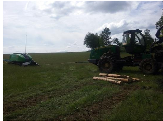
Figure 2 : T-Winch, treuil déporté multi-machines
