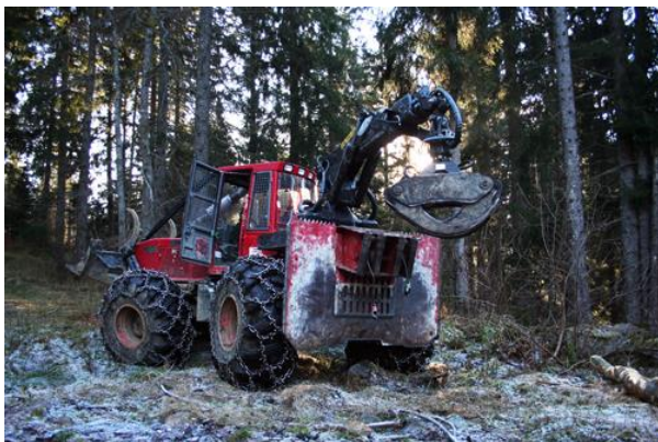
Configuration 4 : Débusqueur double treuil équipé d'une grue et d'un grappin, intervenant principalement en récolte de gros bois en montagne : 2 lignes de câble chacune équipées d'un choker automatique et d'un culot métallique en terminaison
