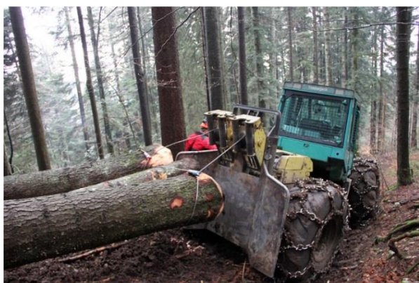
Configuration 1 : Débusqueur double treuil, intervenant principalement dans les gros bois (1 à 2 grumes /ligne de câble) : 2 lignes de câble chacune équipée d'un choker automatique et d'un culot métallique en terminaison
