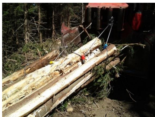
Configuration 2 : Débusqueur double treuil, équipé d'une grue et d'un grappin, évoluant plutôt dans les petits bois et bois moyens (inf 1m 3 ) : 2 lignes de câble équipées chacune de 4 chokers coudés et de 4 élingues. Dans le test, une seule ligne était équipée de 4 chokers automatiques installés sur les élingues
