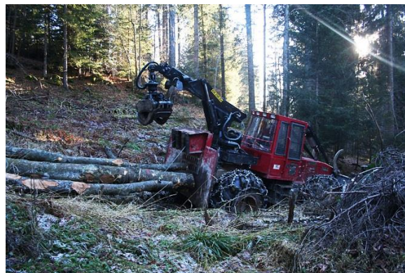
Configuration 4 : Débusqueur double treuil équipé d'une grue et d'un grappin, intervenant principalement en récolte de gros bois en montagne : 2 lignes de câble chacune équipées d'un choker automatique et d'un culot métallique en terminaison
