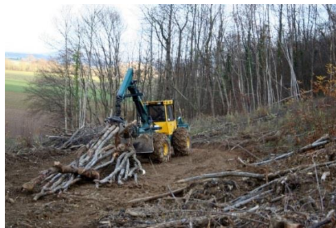
Configuration 3 : Débusqueur double treuil équipé d'une grue et d'un grappin large, intervenant principalement en récolte de bois énergie (groupes de javelles) : 2 lignes de câble chacune équipées d'un choker automatique et d'un culot métallique en terminaison
