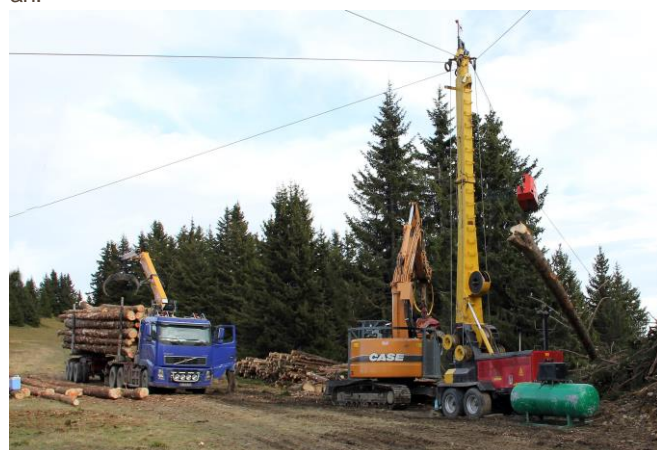
Photo 4 : Câble mât, engin de reprise et camion de chargement
