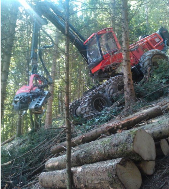
Photo 2 : Tracks, tilt de cabine (insuffisant) sur une machine de bûcheronnage équipée d'un treuil d'assistance.
