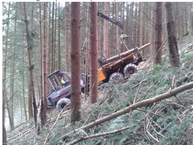
Photo 5 : Porteur et treuil d'assistance, berceau réduit
