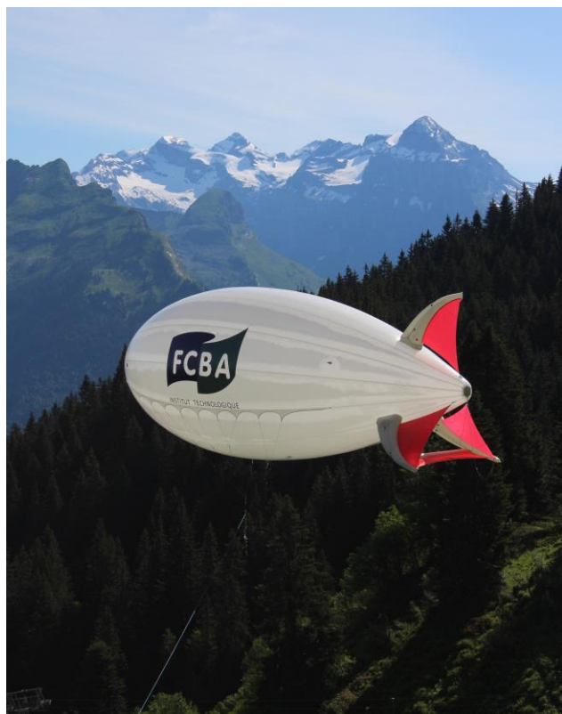
Photo 9 : prototype du ballon débardeur en test
