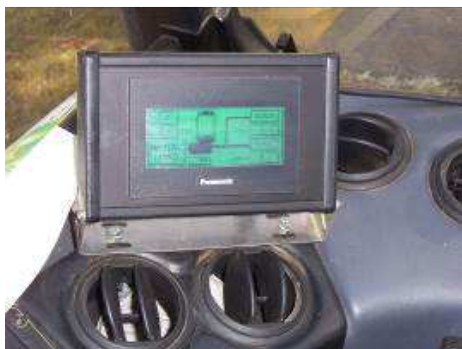
Le boîtier d'interface opérateur pour le réglage des débits dans la cabine
