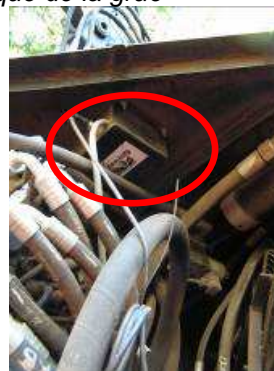
Unité de contrôle électronique connectée à la pompe, au boîtier d'interface opérateur, au signal de scie et à une alimentation électrique
