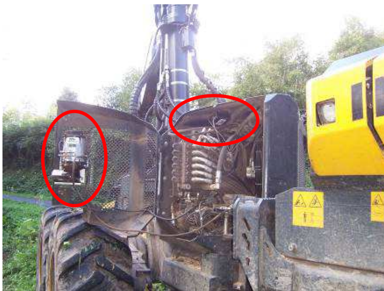
Exemple sur la Ponsse Ergo : installation de la pompe, du réservoir et de l'unité de contrôle du système EnviroSYS dans le compartiment hydraulique de la grue
