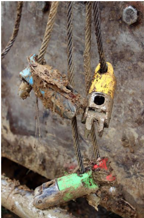
Photo 4 : La boue peut bloquer l'ouverture automatique des chokers
