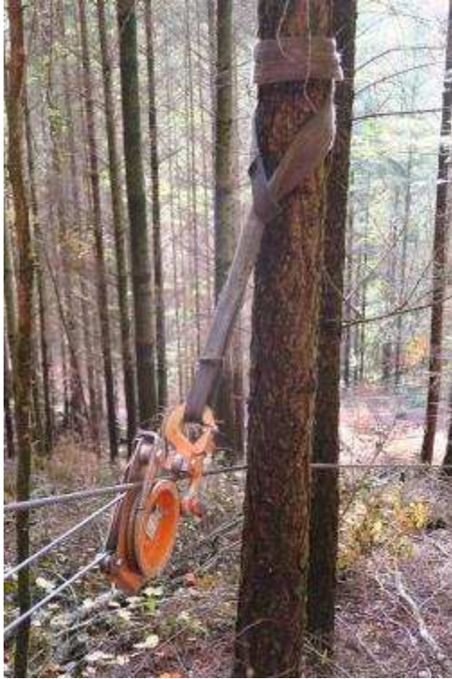
Poulie du câble retour, accrochée sur le porteur (cabestan) à hauteur d'homme
