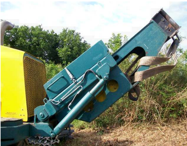
Treuil HSM avec la possibilité d'incliner le treuil à 50°
