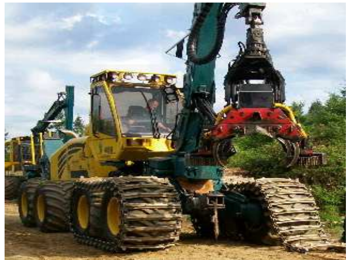
Mise en place des tracks avant la coupe
