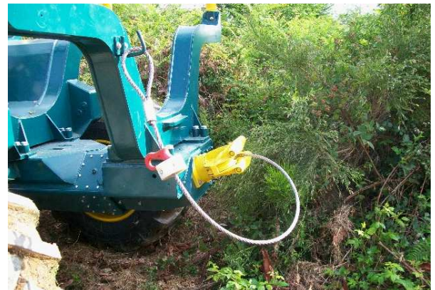
Treuil synchronisé. Câble : 16 mm compacté, longueur 450 m.
