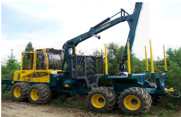
Le Porteur HSM 208F équipé d'un moteur Iveco d'une puissance de 175 kW.
