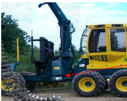
Le Porteur HSM 208F équipé d'un moteur Iveco d'une puissance de 175 kW.
