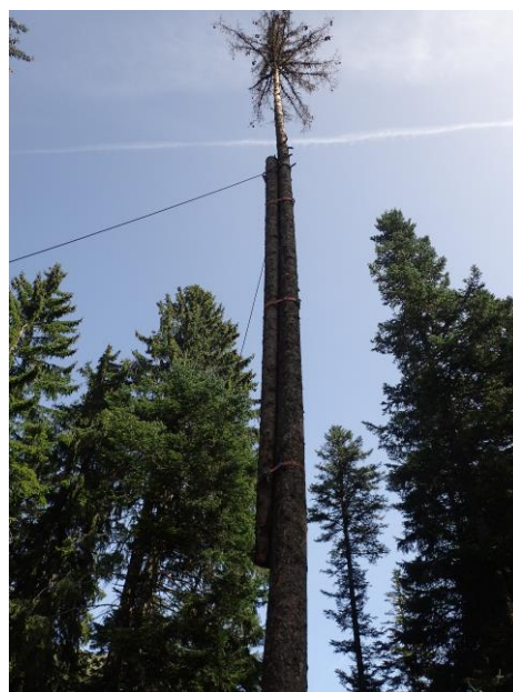
Photo 2 : Un support intermédiaire renforcé en démonstration sur le site école de l'Hongrin en Suisse Romande
