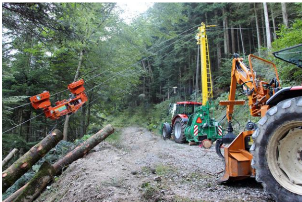
Photo 1 : Petit câble mât sur attelage 3 points et engin de reprise (ici un tracteur-débusqueur à grue)
