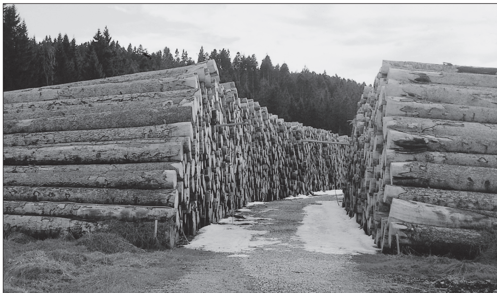
Stockage résineux sous aspersion Photo Ph. LACROIX
