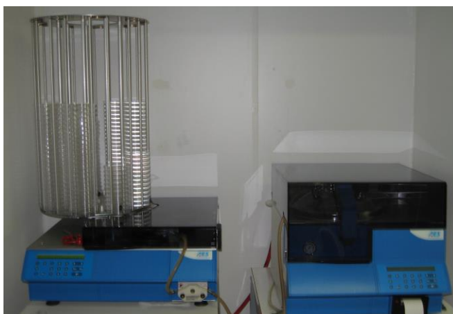
Photo 1 : équipement de coulage automatique de milieu de culture en boîtes de Petri, de l'autoclave (à droite) au distributeur (à gauche) (photo ©FCBA)
