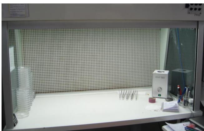
Photo 2 : plan de travail sous hotte à flux laminaire (photo ©FCBA)
