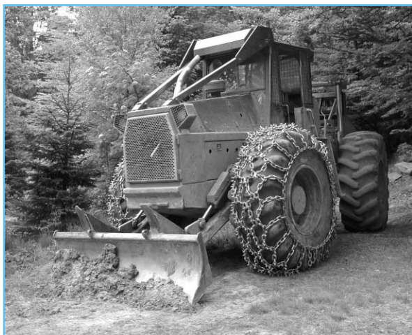
Les équipements facilitent le travail : chaînes, lame avant, griffes...
