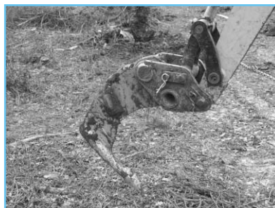
La dent de cultisoussolage effectue un travail du sol localisé.
