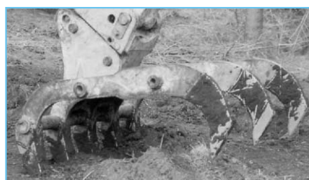
Le râteau scarificateur permet un travail du sol superficiel.
