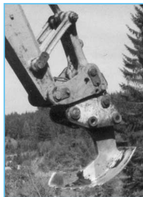
La dent de déchetage : une utilisation anecdotique.
