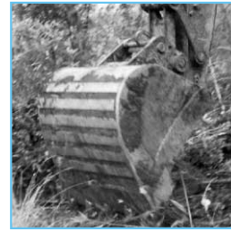
Le godet : outil de nettoyage parmi les plus utilisés en Limousin.
