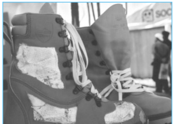
Les chaussures et bottes anti-coupures comportent des couches de textile synthétique du même type que les pantalons.
