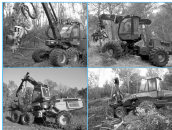
Les différents modèles d'abatteuses suivis dans les chantiers de pin d'Alep : Timberjack, Valmet, Caterpillar et Ponsse.
