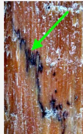
Lignes de démarcation noires dans le bois (formées par le champignon pour se protéger de la sécheresse et de la concurrence)
