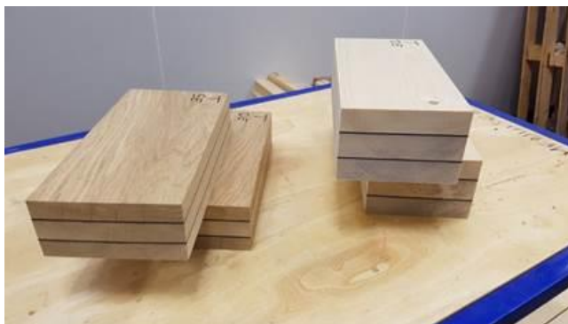
Photo 2 : configuration d'éprouvette d'essai Bois Lamellé Collé # BLC adaptée de la norme EN 302-2 - 3 lamelles de bois de 30 x 150 x 500 mm avec 2 lamelles de carbonés de 1.2 x 150 x 500 mm intercalées
