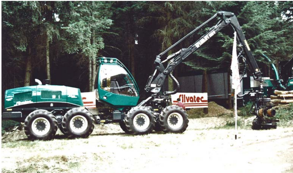
Photo 1 : une des machines de bûcheronnage les plus répandues en Franche-Comté : Silvatec Sleipner à 8 roues.
