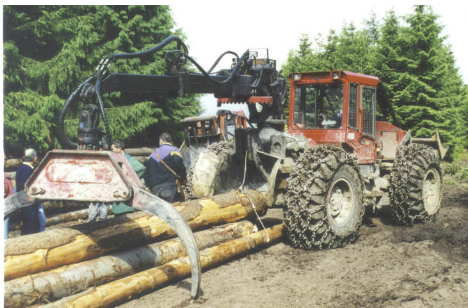
Photo 2 : le débusqueur à grue + grappin permet la manutention et le tri des bois. Plusieurs entrepreneurs de la région ont acquis ce genre de matériel mais en l'équipant aussi d'un treuil pour accéder aux bois sur pentes fortes.
