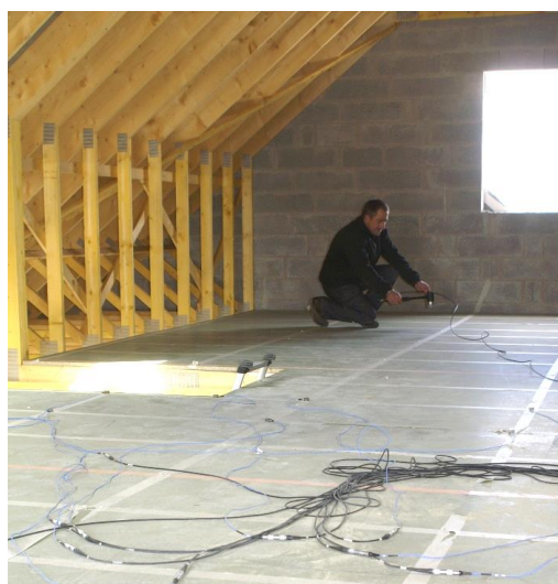
Figure 2 : Détermination des modes propres du plancher via les mesures d'impact au marteau pour le plancher sans élément de second œuvre.
